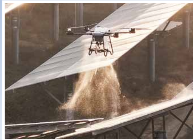
无人机清洗光伏板。
